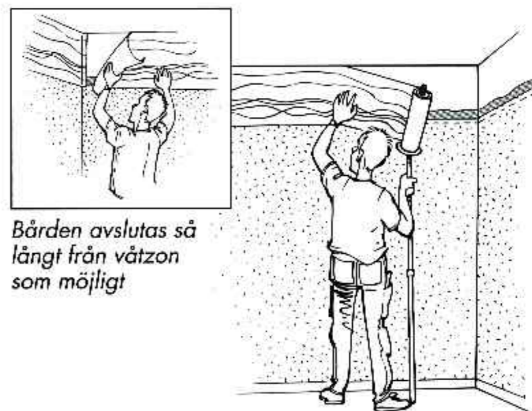
Bården monteras med överlapp
