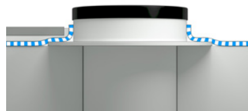
Fig. 35. Tätning av rörgenomföring i golv med uppvik.
