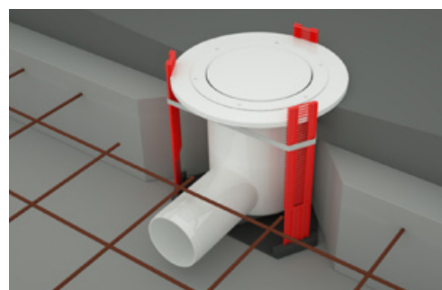
Fig. 13. Fixering av golvbrunn med hjälp av fixtur inför betonggjutning.
