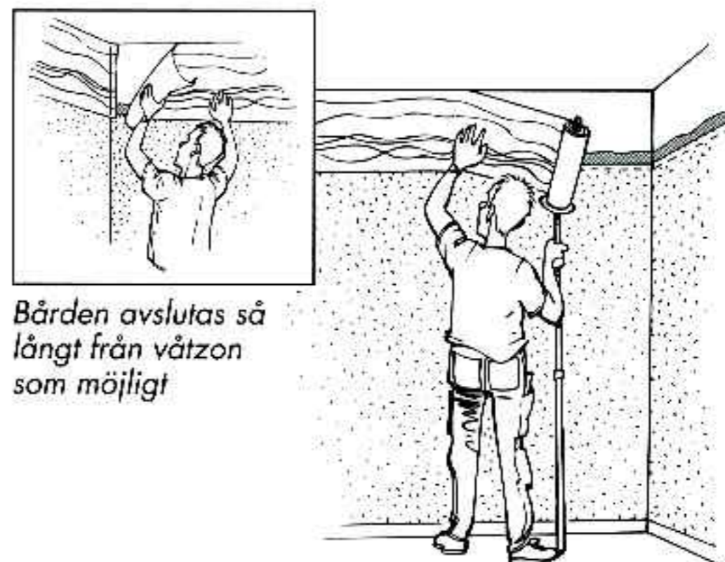
Bården monteras med överlapp
